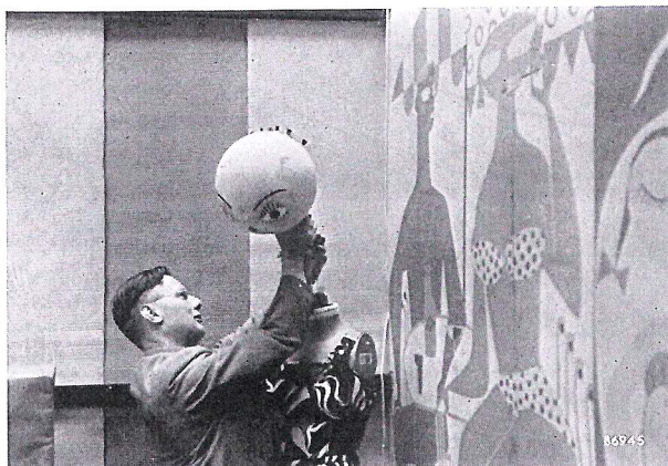
Fig. 4. Het hoofd van „Philiroze” wordt gemonteerd. Daar de pruiк nog ontbreekt, kan men op het hoofd de aansluitklemmen voor de stroomtoevoerdraden zien.
