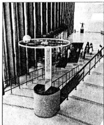
Het voetstuk van dichtbij. In het midden de ronde doos die de bal steeds een zetje geeft.
