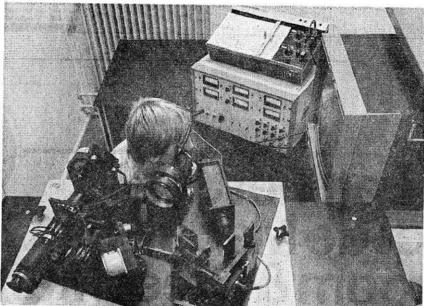
Met dit apparaat kunnen de oogbewegingen van een televisiekijker precies worden geregistreerd. Een infraroodstraal, die onzichtbaar is voor de proefpersoon, wordt op het oog gericht. Het oogvlies reflecteert de straal.
