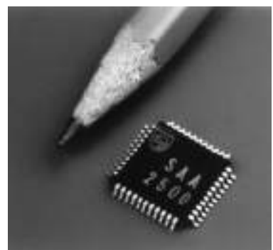
Figuur 2: De SAA2500 van Philips die MPEG-1 Layer I en II decodeert (1993). The SAA2500 of Philips which decodes MPEG-1 Layer I en II (1993).
